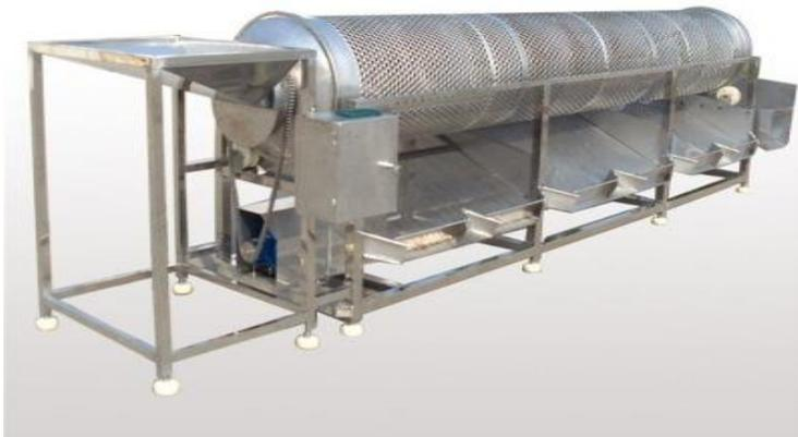
图 2-6 螺旋滚筒分级设备
