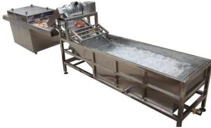
图 2-15 连续式气泡清洗机
