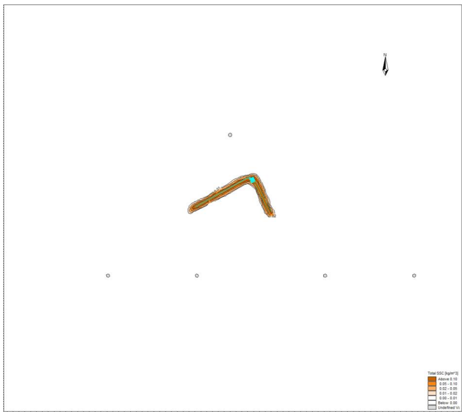
图 4.2.3-7 海缆敷设施工产生悬沙增量包络线范围图（0.8 层）
