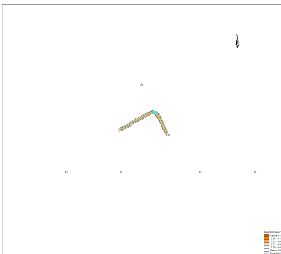
图 4.2.3-6 海缆敷设施工产生悬沙增量包络线范围图（中层）
