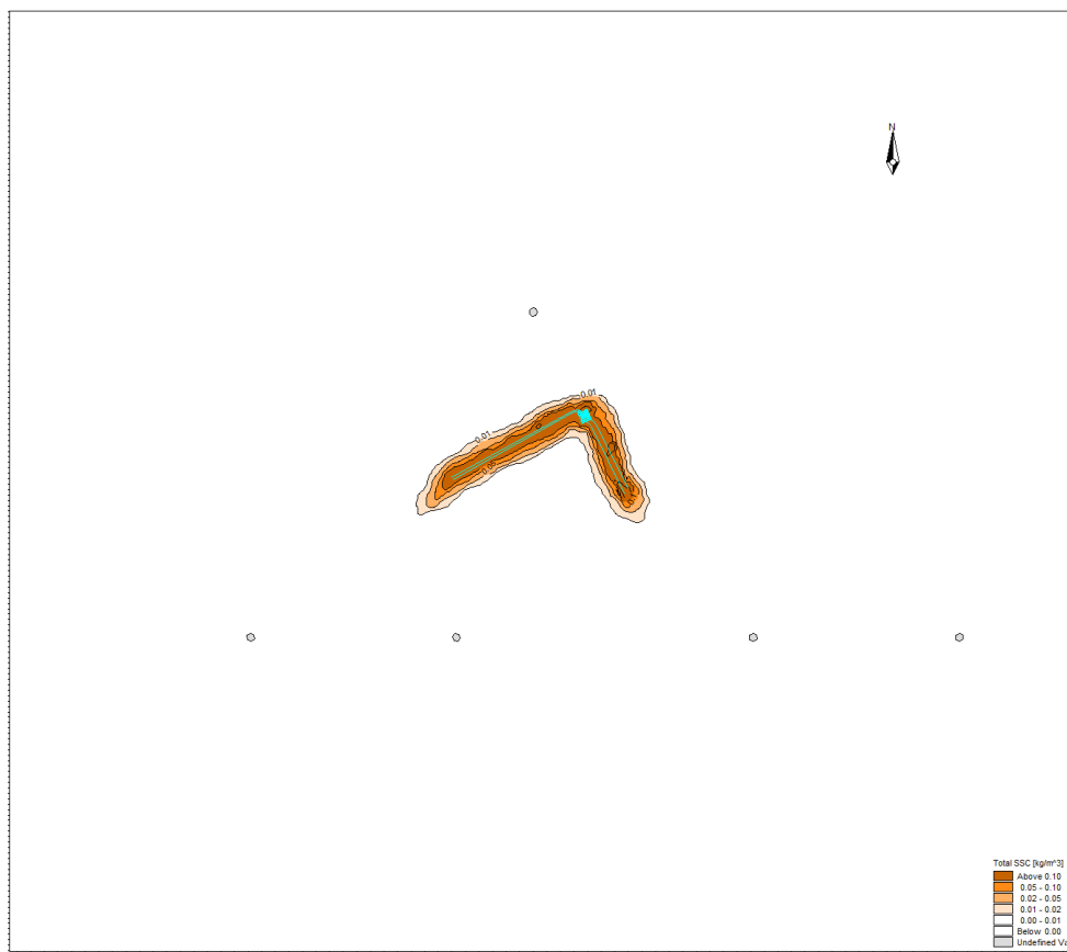
图 4.2.3-8 海缆敷设施工产生悬沙增量包络线范围图（底层）
