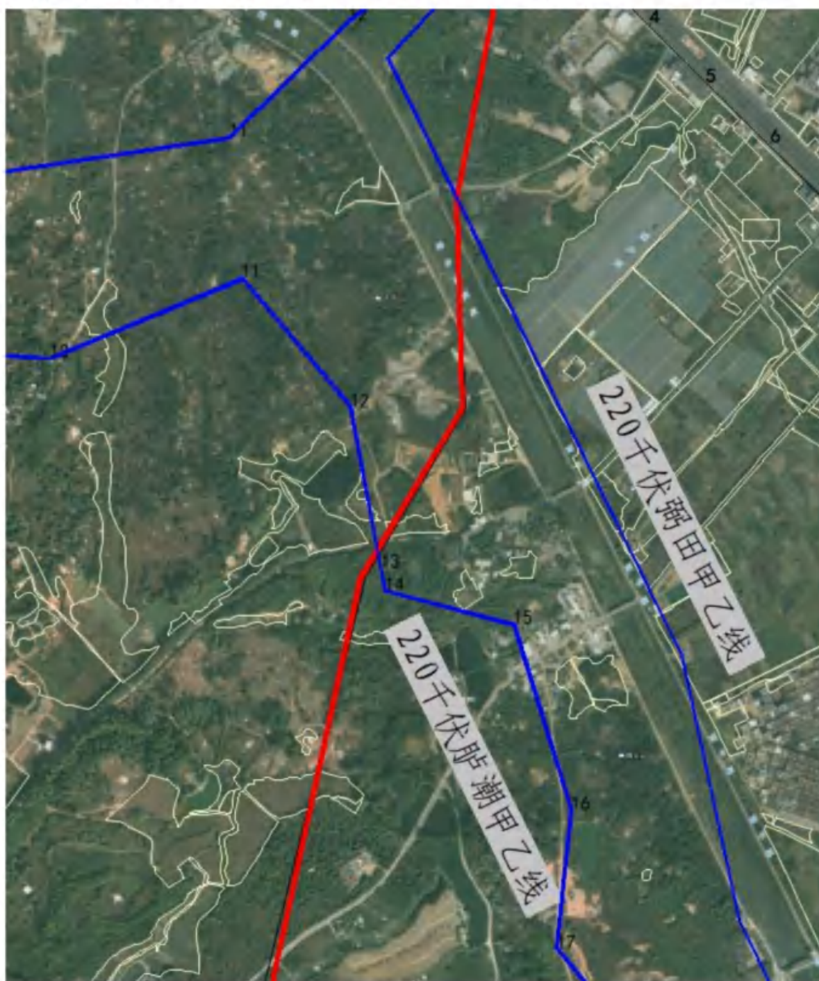
图 7.4.5 拟建线路穿越现有 220kV 线路
