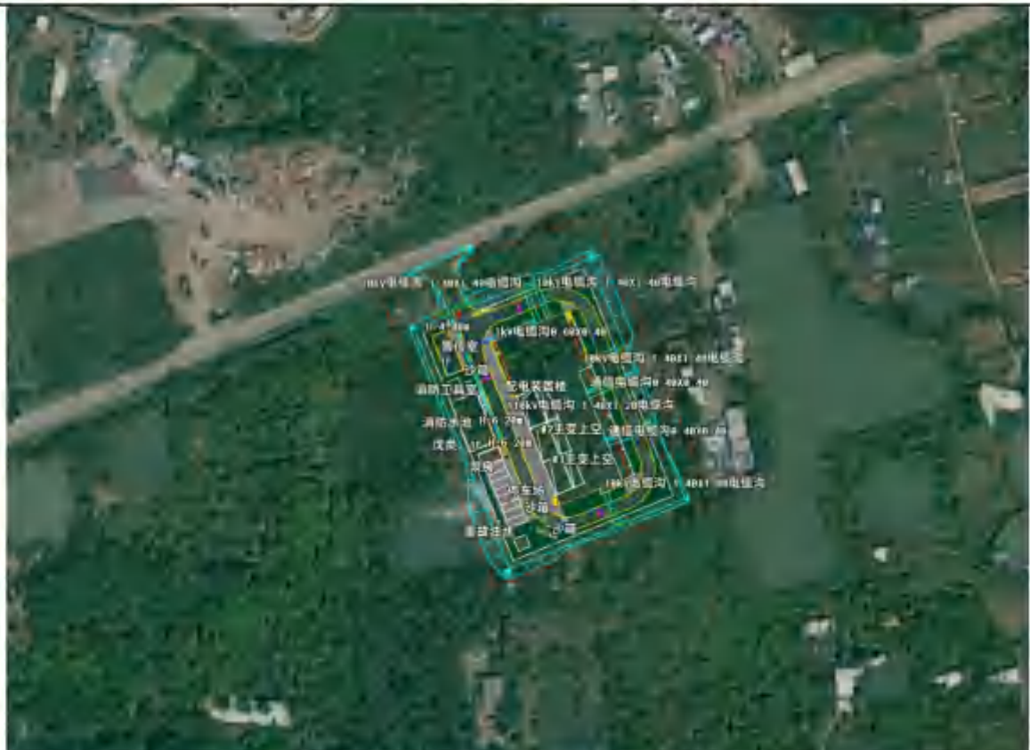
图 2.6-1 新建 110 千伏大亨站现场布置图
