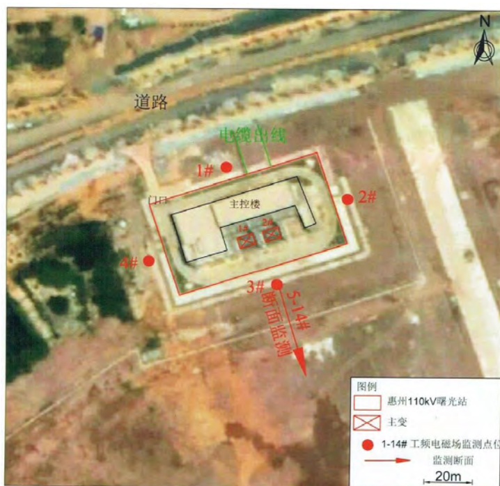
图 3 惠州 110 千伏曙光变电站监测布点图
