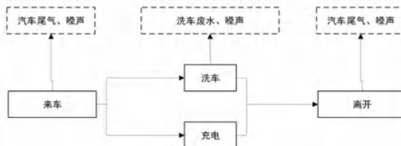
图 2-4 洗车、充电工艺流程及产污环节图
