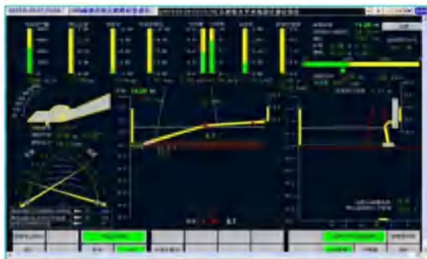
图 3.2.4.4-4 耙吸式挖泥船定深控制界面
