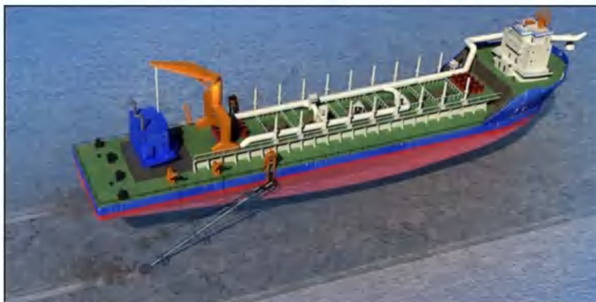
图 3.4.4-2 耙吸式挖泥船施工三维示意图
