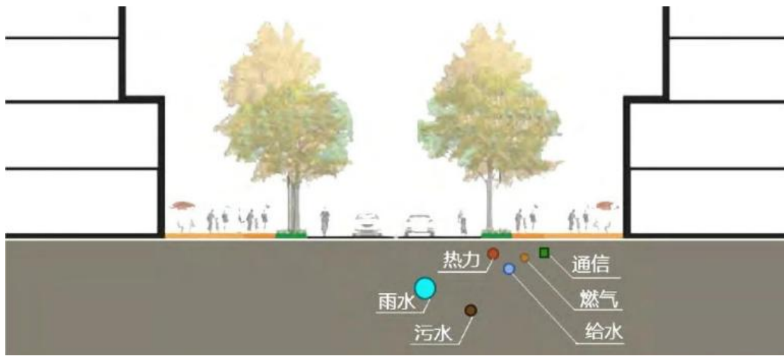
图 5-9 水电气等设施铺设示意图
