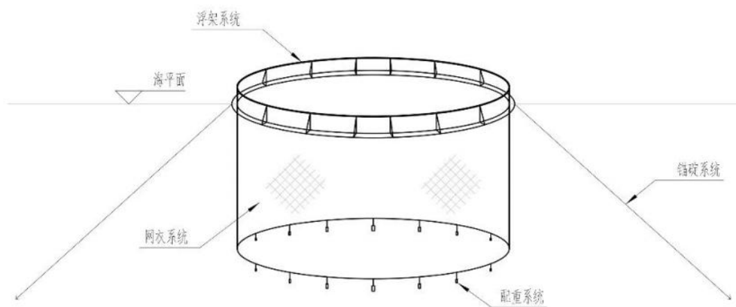
图 1.6.2-2 网箱锚碇系统示意图
