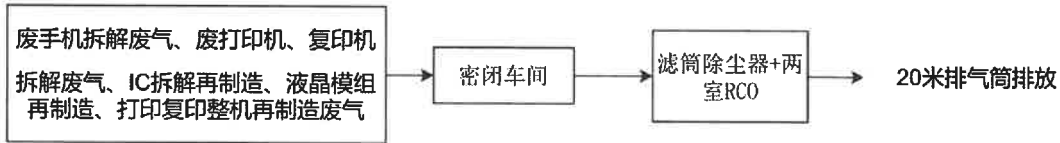
图 5.1.2-5 废手机拆解废气，废打印机、复印机拆解废气，IC 拆解再制造，液晶模组再制造，打印复印整机再制造废气收集净化流程
