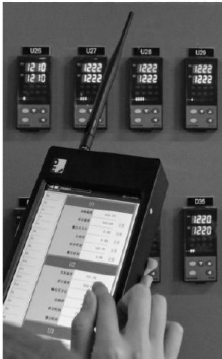
图 2 使用手持移动设备远程修改温度表参数
