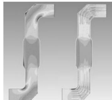
(b) 烟气换热器内部速度分布图
